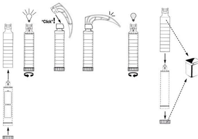
La coque de protection jetable XP est prévue pour être le « boîtier externe » des boîtiers de laryngoscope HEINE. Le boîtier de laryngoscope HEINE est placé dans la coque de protection jetable ; il suffit de tourner le culot pour que l'éclairage s'allume. Après utilisation, il suffit de dévisser le culot pour libérer le boîtier de laryngoscope qui est resté propre, puis de se débarrasser de la coque XP.
